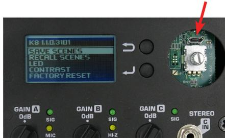
2. En el módulo de amplificación del altavoz, use una herramienta de punta plana para levantar la perilla del selector rotatorio haciendo palanca. Verá un puerto micro USB al lado del selector rotatorio. Conecte el cable al puerto y conecte el otro extremo a un puerto USB disponible en la computadora.
