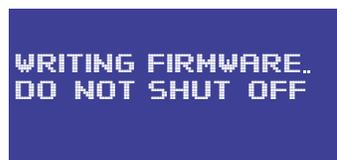
6. Cuando el firmware se haya cargado en la memoria interna, el módulo de amplificación del altavoz lo escribirá en el firmware permanente. Esto tarda más o menos tres o cuatro segundos, pero es de vital importancia que este paso no sufra interrupciones. Si se interrumpe, el módulo quedará completamente bloqueado.
