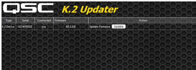
3. Encienda el módulo de amplificación. La aplicación K2Updater debería detectar e identificar el modelo K.2 conectado a la computadora y mostrarlo en una tabla.
