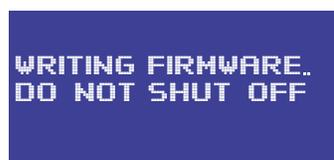
6. Nachdem die Firmware in den internen Speicher des Lautsprechers geladen wurde, wird sie vom Endstufen-Modul in die permanente Firmware übertragen. Dies dauert nur etwa drei bis vier Sekunden, aber es ist sehr wichtig, dass dieser Schritt nicht unterbrochen wird, da das Modul sonst „blockiert“ wird.
