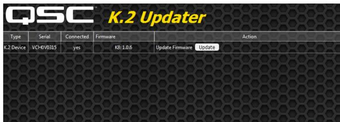
3. Schalten Sie das Endstufen-Modul ein. Der K2Updater sollte den mit dem Computer verbundenen K.2 Lautsprecher erkennen und in einer Tabelle anzeigen.
