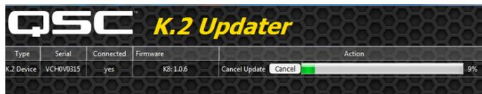
5. Die Aktualisierung dauert normalerweise weniger als zwei Minuten. Ein Fortschrittsbalken im K2Updater zeigt den Stand der Aktualisierung an. Zusätzlich wird der Fortschritt des Firmware-Ladevorgangs auch am LC-Display des Lautsprechers angegeben. Diese Übertragung der neuen Firmware vom Computer in den internen Speicher des Lautsprechers ist der Teil des Aktualisierungsvorgangs, der am meisten Zeit beansprucht.
