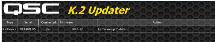
7. Wenn das Update abgeschlossen ist, wird die Meldung **Firmware up to date** angezeigt.
