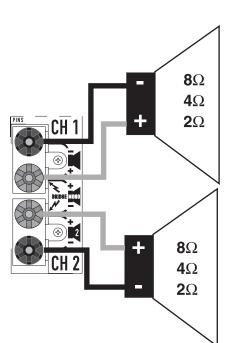
Stereo, bi-amp, or parallel mode Modes stéreo, bi-amp ou parallèle Stereo-, Bi-amp- oder Parallelbetrieb Modos estéreo, bi-amp o paralelo
