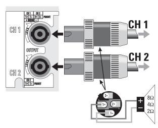
2 channels/canaux/Kanäle/canales & 2 Speakons (Stereo, bi-amp, or parallel mode; Modes stéreo, bi-amp ou parallèle; Stereo-, Bi-amp- oder Parallelbetrieb; Modos estéreo, bi-amp o paralelo)
